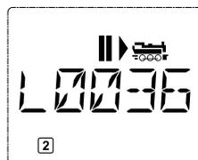
Machine à l'arrêt (l'écran affiche le symbole »II«) l'écran indique le dernier sens de circulation de la machine. On peut ainsi facilement vérifier si les feux, éventuellement éclairés, correspondent effectivement au sens de marche de la machine, donc »feux blancs« en tête du convoi et »feux rouges« à l'arrière.
